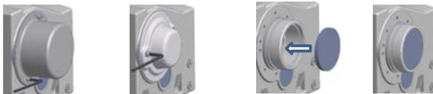
Obr. 13: Montáž hřídelových krytů příslušenství SH, H a H66
