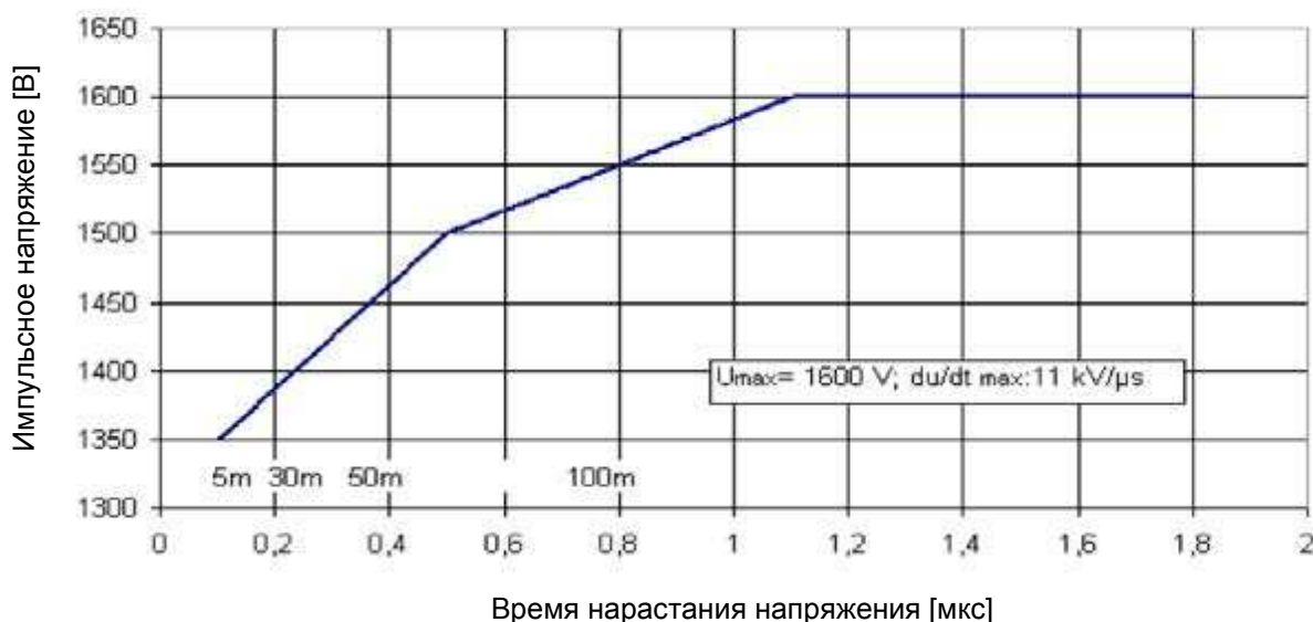
Допустимое импульсное напряжение в зависимости от времени нарастания
