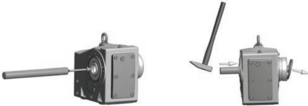
Abbildung 6: Demontage der werkseitig montierten Verschlusskappe
