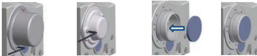
Abbildung 13: Montage der Abdeckhaube Option SH, Option H und Option H66
