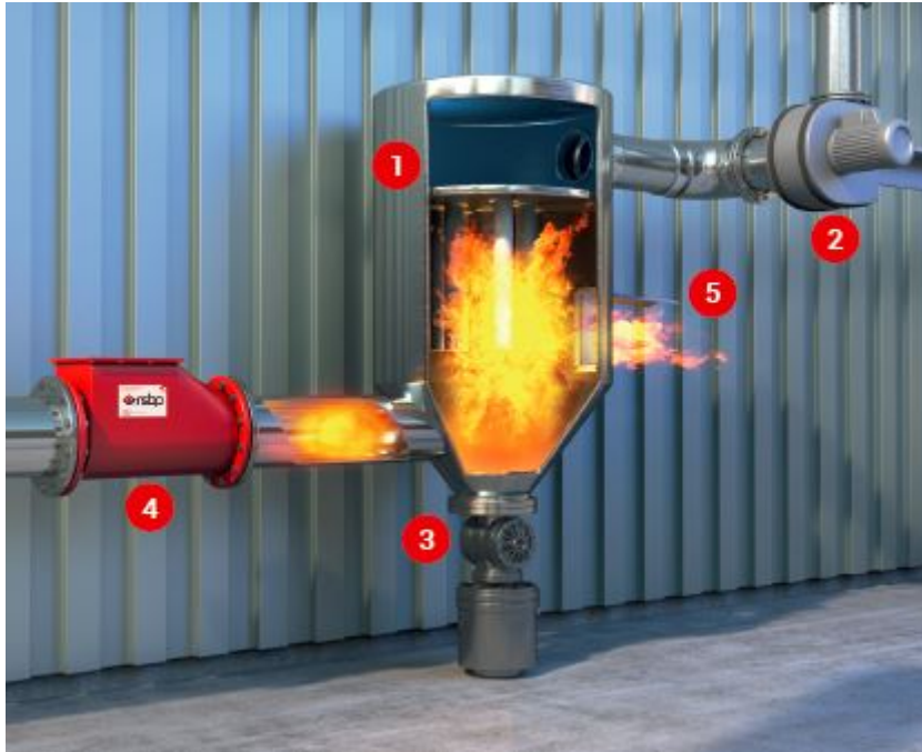
Obr. č. 2 – Schéma funkce zpětné klapky
