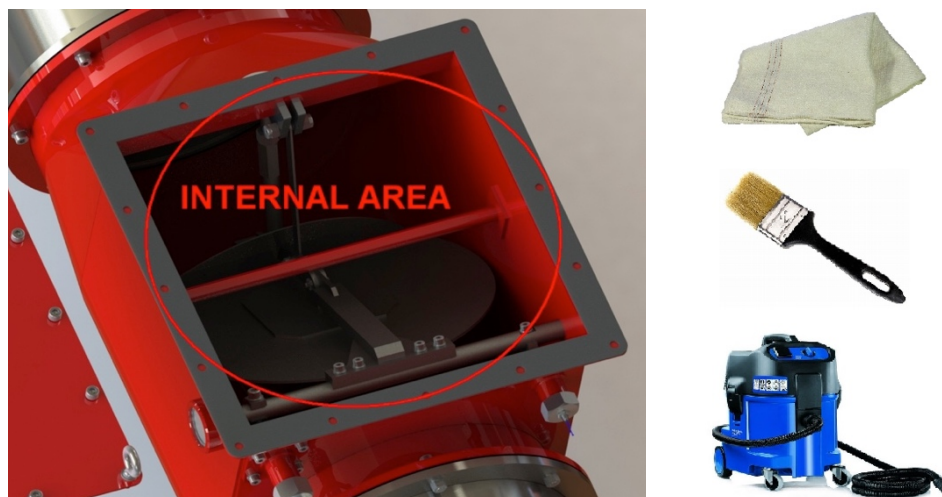
Obr. 25 – Otevřená zpětná klapka (prostor, který je nutno vyčistit, vhodné pomůcky k čištění)
